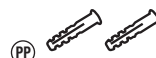
PP 2 x taquetes cortos de plástico (para el sujetador para control remoto)
